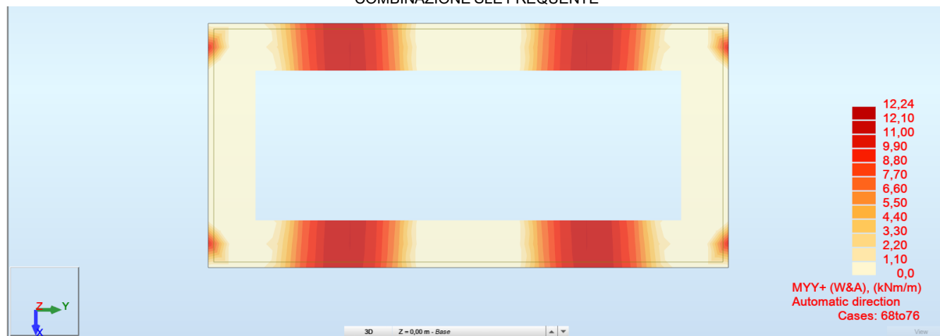
FIG. 71– INVILUPPO SUPERIORE MOMENTO FLETTENTE (WOOD&ARMER) DIREZIONE Y COMBINAZIONE SLE FREQUENTE
