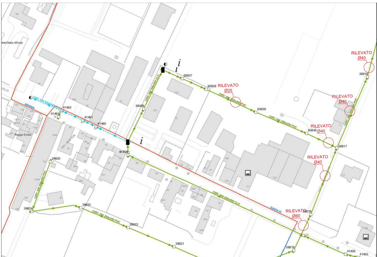
Figura 1: cartografia IRETI-reti acque esistenti nell'area oggetto di intervento modificata con rilievo in sito (fonte: IRETI)
