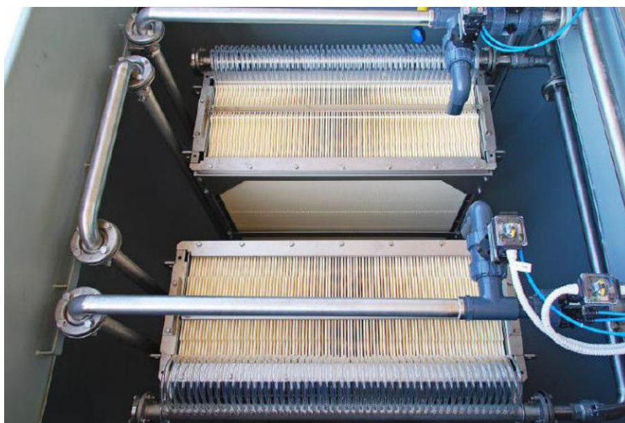
Figura 1 - moduli di membrane per ultrafiltrazione
