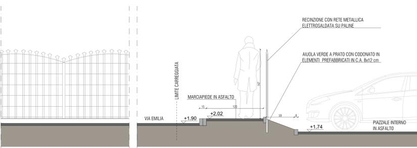
DETTAGLIO RECINZIONE ESISTENTE - SEZIONE A-A scala 1:25
