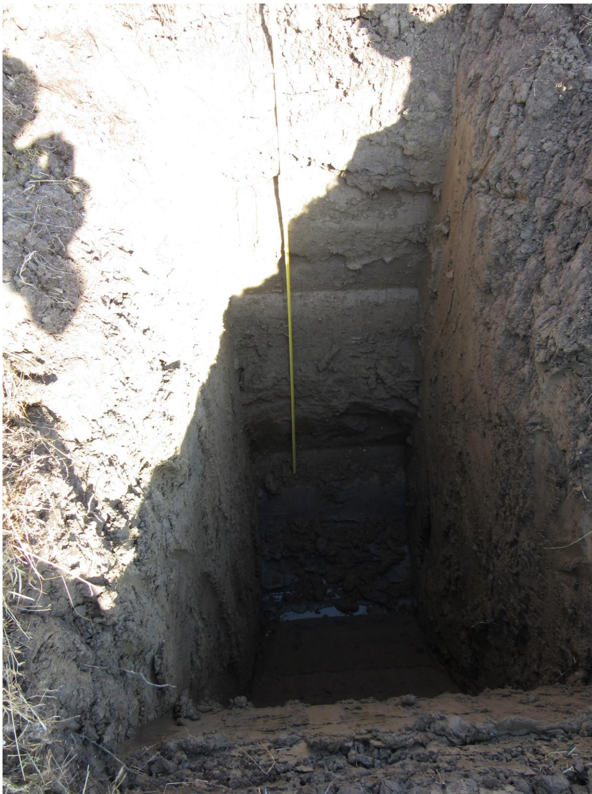
Foto n.2: S2 . Si osserva l'argilla azzurra al fondo dello scavo con modesta presenza di acqua proveniente dalla base del III strato.
