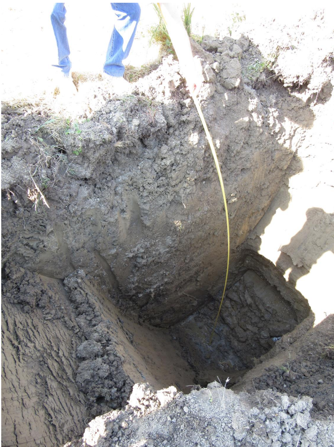
Foto n.4: S4. . Si osserva l'argilla azzurra al fondo dello scavo con modesta presenza di acqua proveniente dalla base del III strato.
