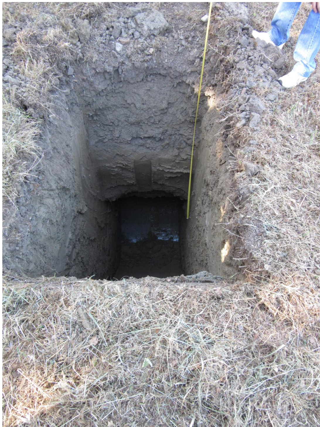
Foto n.1: S1 . Si osserva l'argilla azzurra al fondo dello scavo con modesta presenza di acqua proveniente dalla base del III strato.
