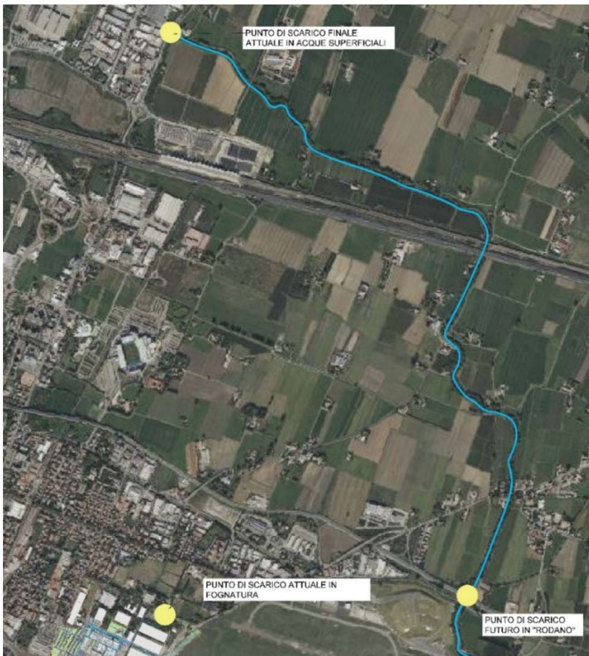
Fig. 16. Inquadramento con indicazione del recapito attuale in fognatura e del futuro recapito nel Rodano
