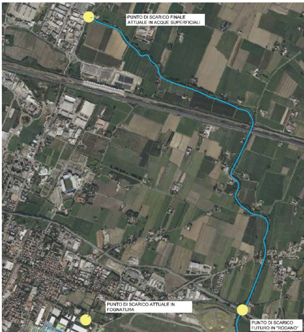
Fig. 3. Inquadramento con indicazione del recapito attuale in fognatura e del futuro recapito nel Rodano
