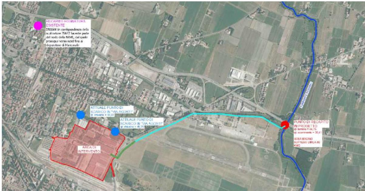
Figura 38 - Ipotesi di tracciato del condotto delle acque bianche dall'area di drenaggio Piazzale Europa - area ex Reggiane. Il Torrente Rodano è indicato in blu, la parte di condotto già realizzata in verde e la parte ancora da realizzare in azzurro.
