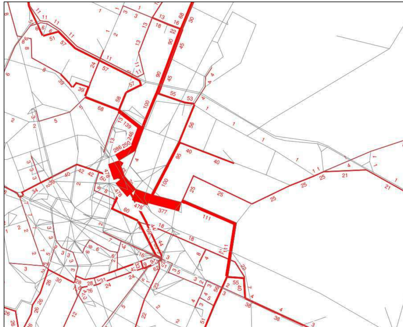
Assetto SDF+Ramazzini – percorsi dei flussi in attraversamento del p.l. di viale Ramazzini in direzione est
