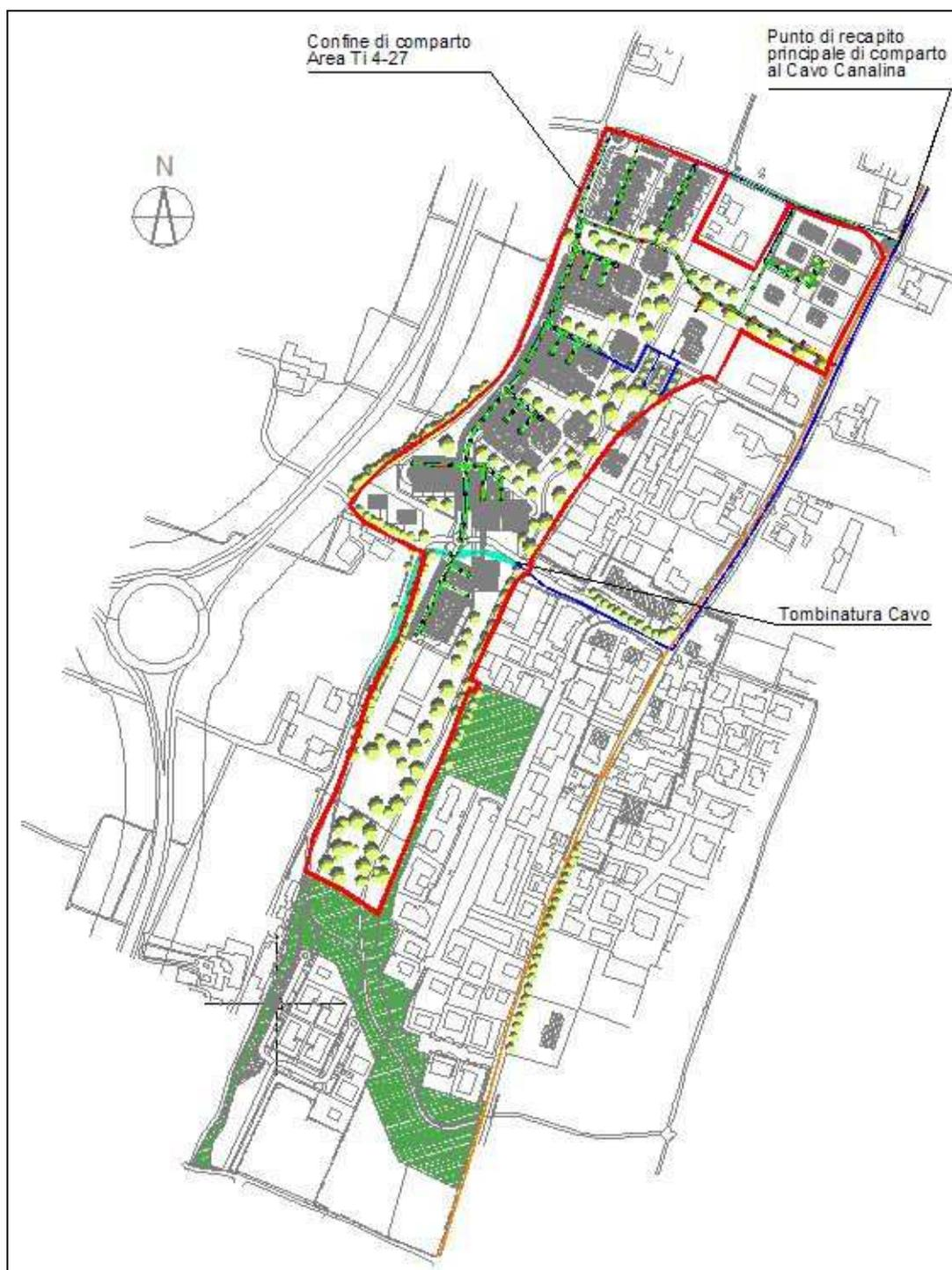
**Figura 3 – Area Ti 4-27: inquadramento territoriale di comparto con indicazione dei punti di recapito principale al Cavo Canalina e di tombinatura definitiva del canale.**
