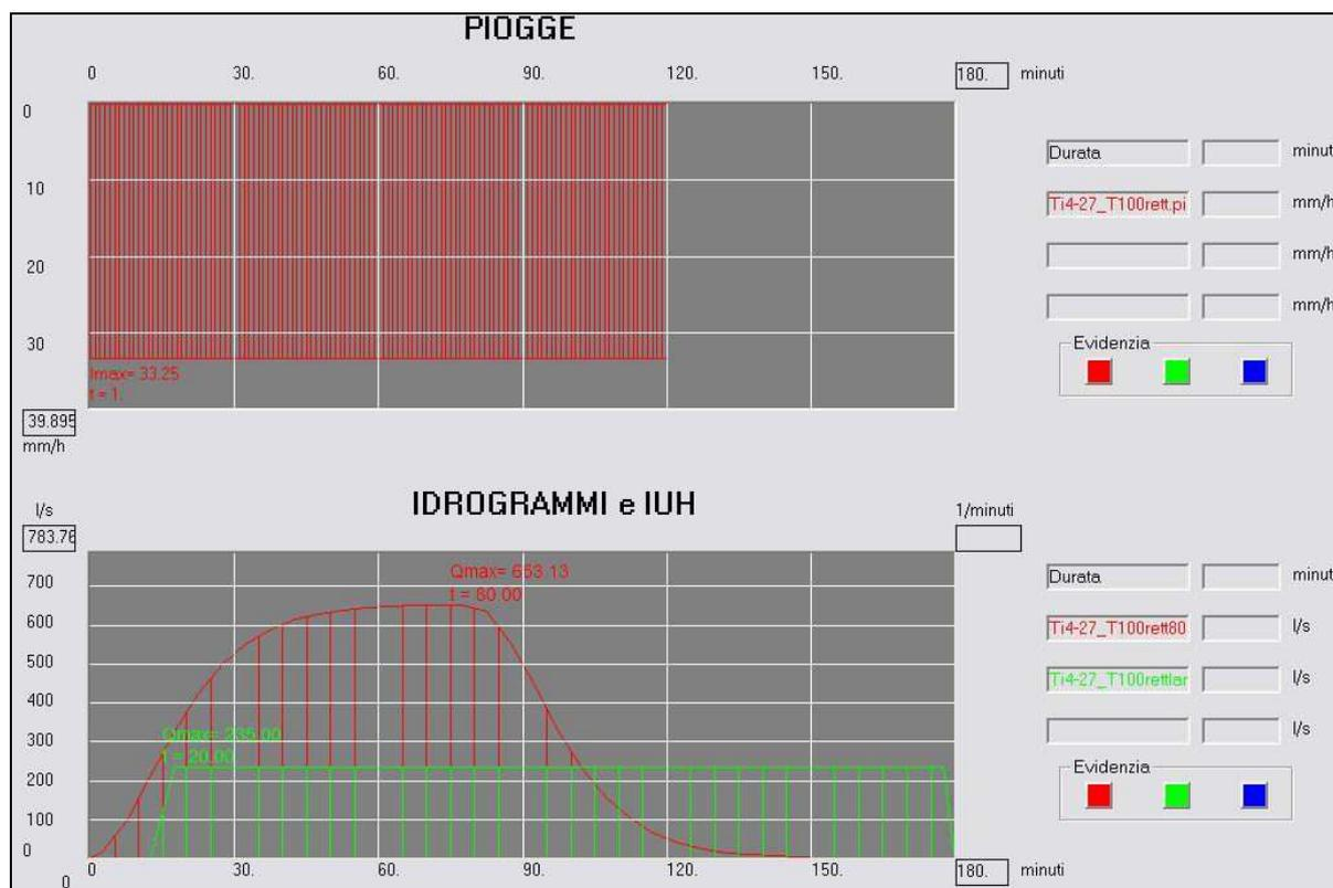
**Tabella 7 – Risultati delle elaborazioni effettuate per il calcolo del massimo valore del volume di invaso minimo necessario per laminare le portate di piena del comparto, con riferimento a TR = 100 anni.**
