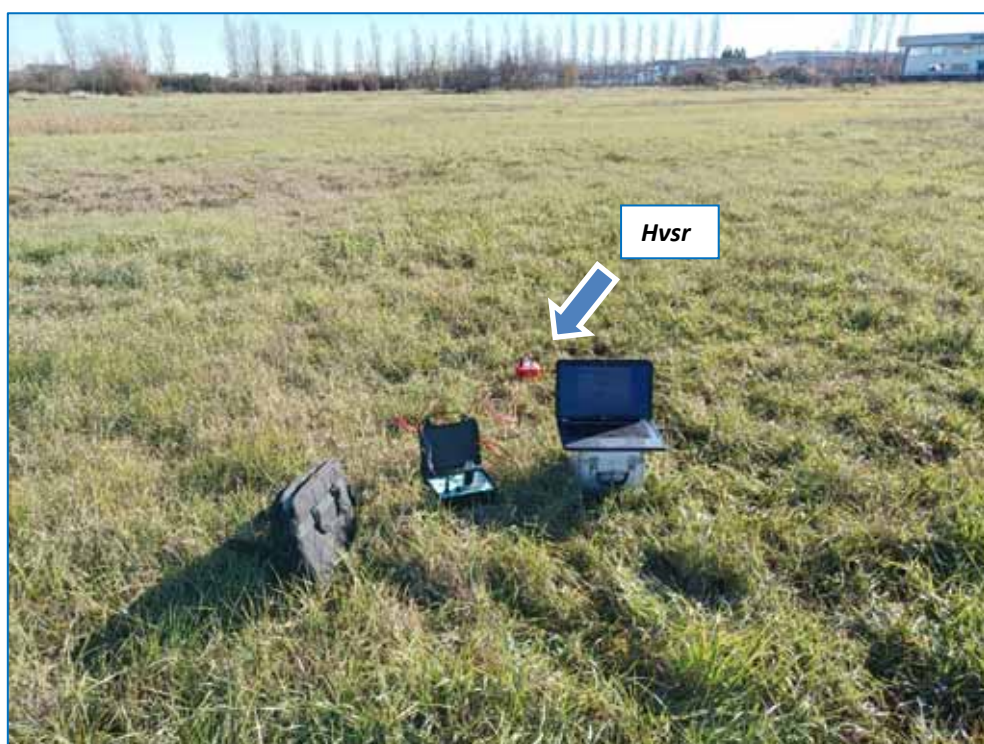
Foto 2: registrazione della frequenze naturali del terreno (Hvsr).
