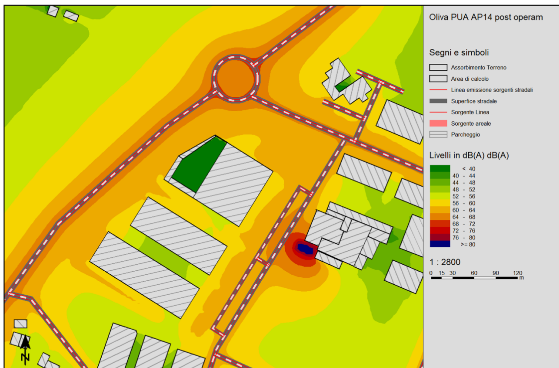
Figura 25: simulazione software (mappatura post operam rumore residuo, periodo diurno)
