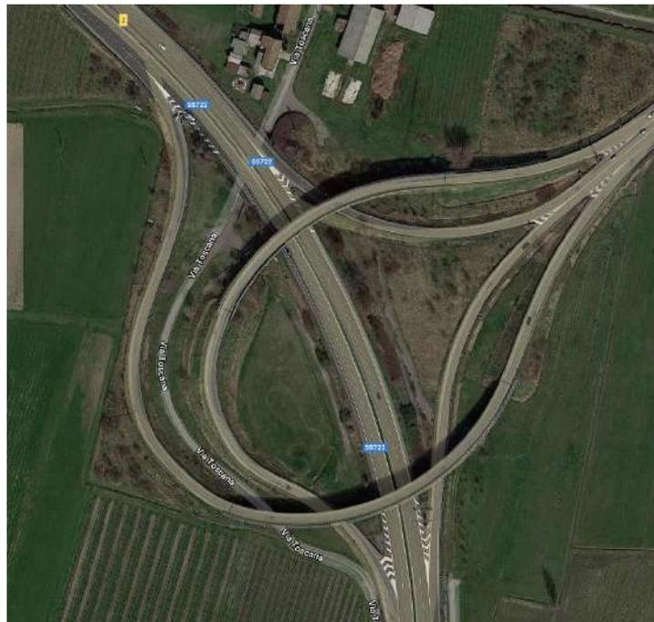
FIG.2.3.7: intersezione a livelli sfalsati tipo trombetta tra tangenziale e SP113 – uscita 2
