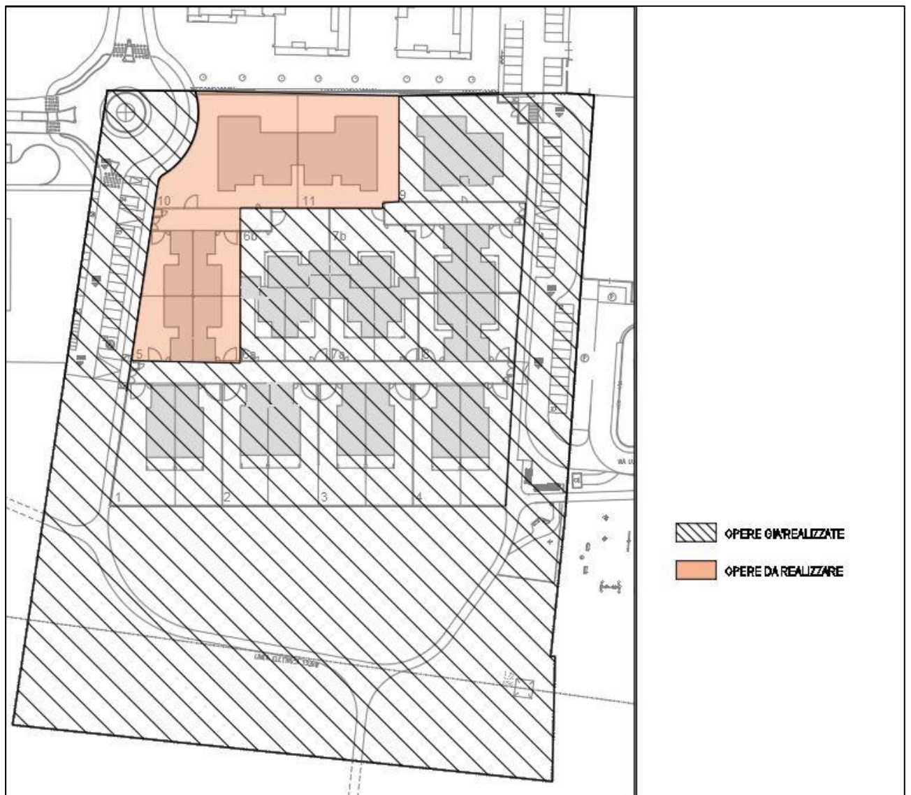
Figura 2 - Planimetria di progetto con indicazione delle opere da eseguire.
