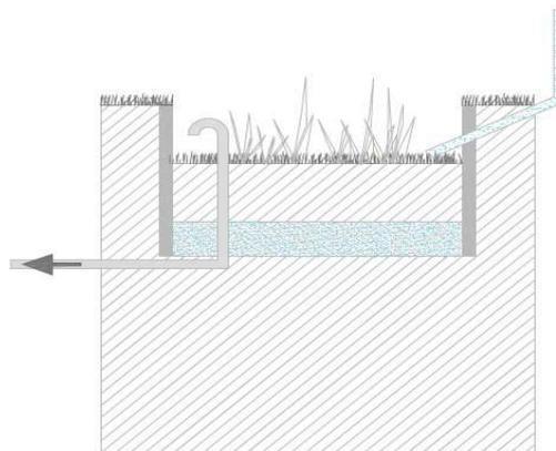
Figura 6. Sezione esemplificativa di vasca verde filtrante
