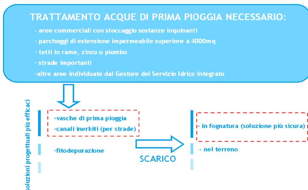
Figura 2. Schema riassuntivo dei sistemi di gestione delle acque di prima pioggia - In rosso sono evidenziate le soluzioni tecniche più sicure qualora le acque siano di bassa qualità
