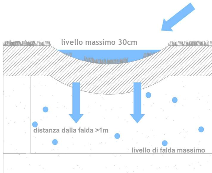
Figura 10. Sezione tipo di un canale inerbito
