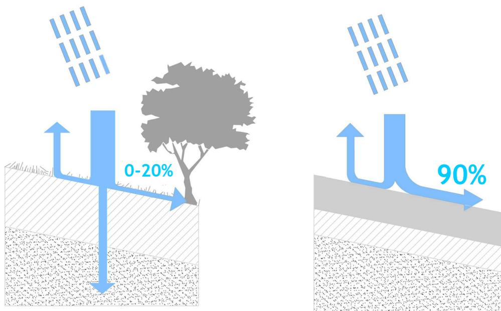
Figura 1. Deflusso superficiale ed infiltrazione con terreni permeabili e non permeabili
